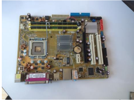
รูปที่ 2.3 แผงวงจรหลัก หรือ เมนบอร์ดคอมพิวเตอร์ (ลักษณะขึ้นอยู่กับแต่ละรุ่นแต่ละยี่ห้อ)
