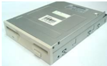
รูปที่ 2.5 เครื่องอ่านดิสก์ไดรฟ์ ขนาด 3.50 นิ้ว
