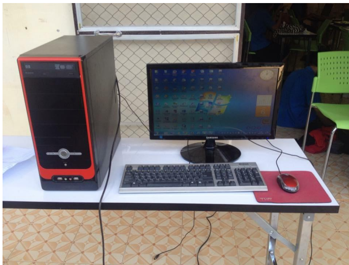
17. นำเครื่องไปประกอบเข้ากับจอภาพ คีย์บอร์ดและต่อระบบไฟฟ้าเพื่อทำการทดสอบและดำเนินการกำหนดค่าไบออสให้กับเครื่องซึ่งจะกล่าวในหน่วยต่อไป
